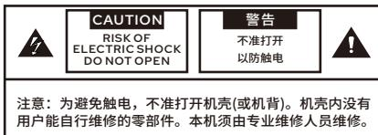
**▲** 三角形内加闪电标志，提醒用户本机内有未经绝缘的“危险电压”存在，可能会发生触电危险。
